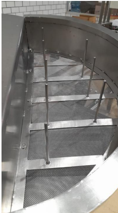
Figura 49. Malla de acero inoxidable sobre la tolva de alimentación
