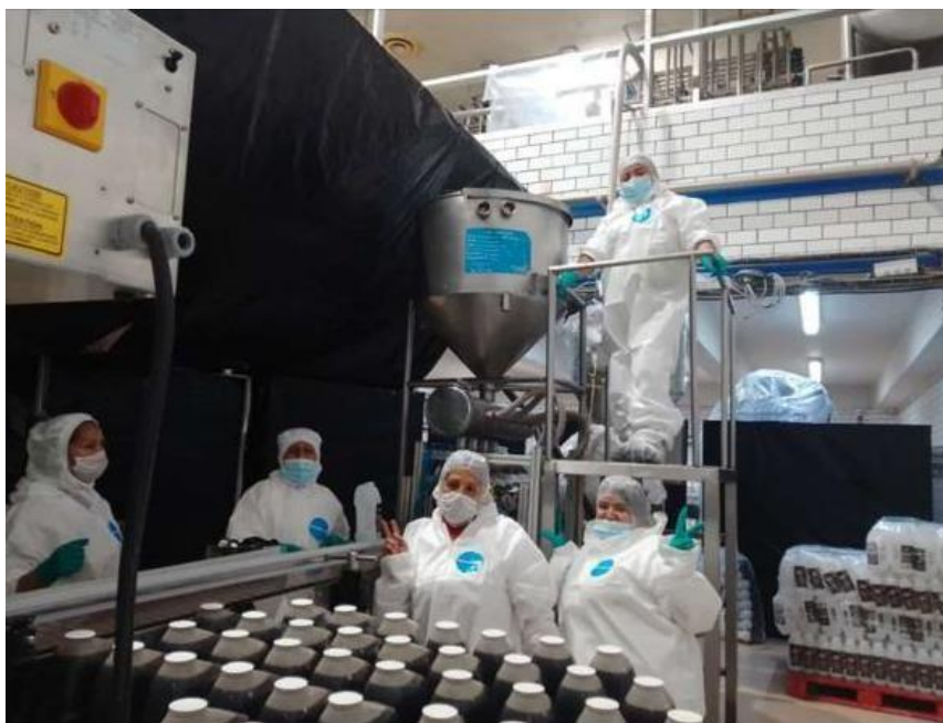
Figura 47. Mamparas como barrera de protección a líneas de producción aledañas
